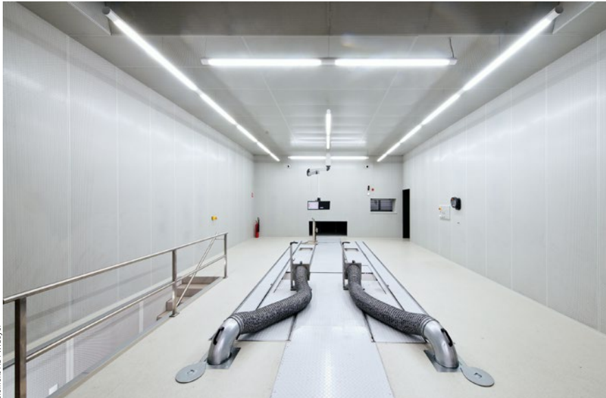
The acoustic dynamometer at Akustikzentrum Lenting
