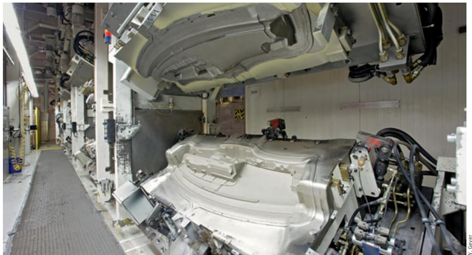
Die Formenträgerwagen werden über eine Zwei-Schienen-Hängebahn durch den mehrstufigen Gießprozess transportiert
