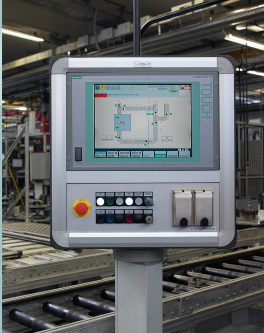
Vor- und Hauptmontage sind jeweils drei zentrale PC-Bedienpanels Simatic PC477 mit 15"-Touchscreen und Standfuß fest installiert. Sie geben den Mitarbeitern einen Überblick über die Fertigungslinie und erlauben ihnen den Eingriff in die Abläufe. Die Prozessvisualisierung an den Stationen erfolgt über Simatic HMI Panels.
