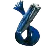
Kablo bağlantısı yapılmış S7-300 ön konnektörü
