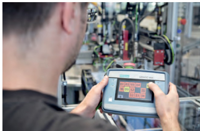
Beim Bau der Montageanlage für die Brandmelder kam das neue, mobile 4-Zoll Panel von Siemens zu einem seiner ersten Einsätze.
