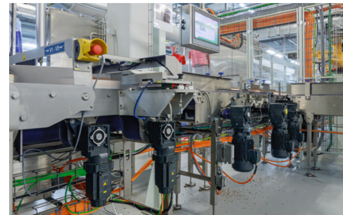
Sinamics S120: Insgesamt 31 Motorachsen machten die Auslegung der Antriebe zu einer Herausforderung.
