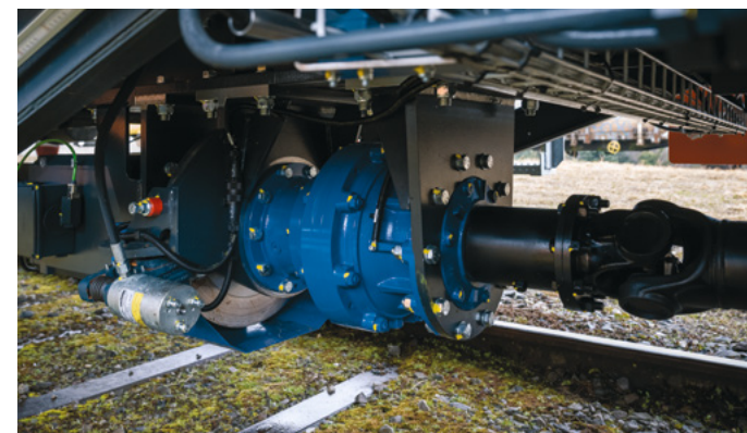
Effizient und leise: Ein 1PH8 Simotics M Kompakt-Synchronmotor mit einer Leistung von 69 kW bewegt den Wagen während der Fahrleitungsarbeiten.
