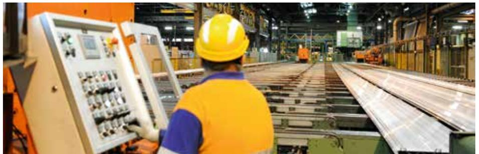
Ein Arbeiter betätigt die Spanschraube, welche die Profile während der Erkaltung mit einer Kraft von 200 Tonnen auseinanderzieht. Ein Verfahren, das die mechanischen Eigenschaften verbessert, indem es die Profile geradlinig macht.
