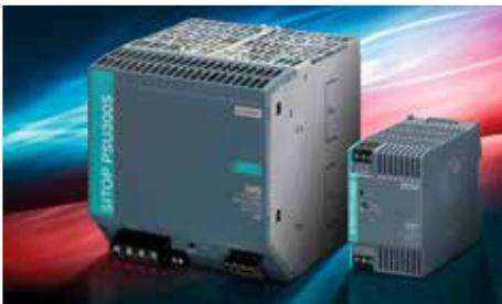
Sitop compact begrenzt die Ausgangsleistung auf 100 VA und ist nach der US-Norm NEC class2 zertifiziert. Die schmale Stromversorgung (24 V/3,7 A) benötigt mit nur 52,5 mm Baubreite wenig Platz auf der Hutschiene und erfordert auch keine seitlichen Abstände zu anderen Geräten. Damit ist sie auch für den dezentralen Einsatz in Schaltkästen prädestiniert. Dank des hohen Wirkungsgrads über den gesamten Lastbereich spart der Anwender Energie.
