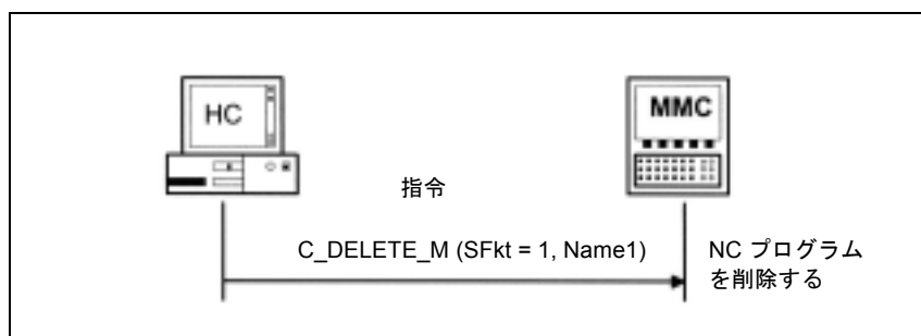
図 5.7 NC プログラムの削除（ホストコンピュータから開始された削除）
