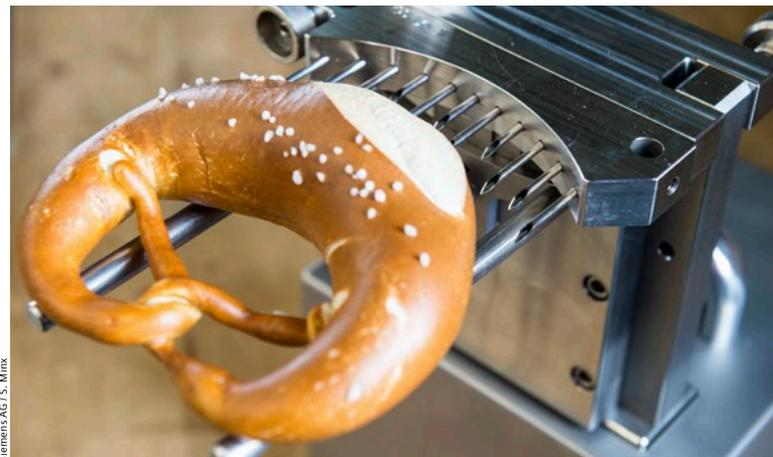
Per Knopfdruck wird Butter bequem und stressfrei in die Brezel gepumpt – und dank LOGO! 8 auch genau in der richtigen Menge
