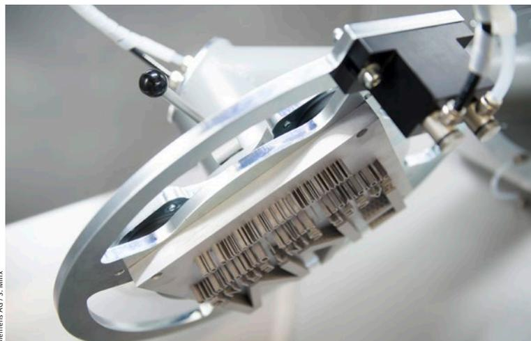
LOGO! 8 steuert den Schwenkarm mit Drehteller, auf dem das Bauteil samt Plattform eingespannt wird
