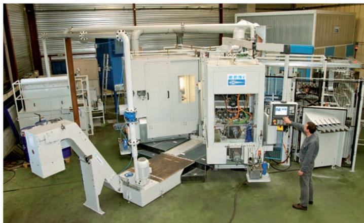
*Télediagnostic et maintenance sont intégrés à l'imagerie de la commande numérique, fruit d'un développement sous SIMATIC WinCC Flexible. A distance, le technicien peut ainsi accéder aux vues présentes sur l'écran du pupitre.*
