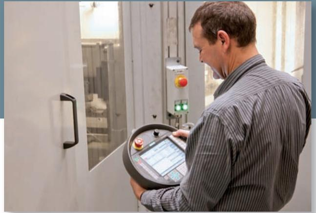
peut bénéficier de fonctions avancées de sécurité machine gérées par SINUMERIK. Par exemple, pour effectuer un réglage au plus près de l'unité d'usinage, porte ouverte et dans la zone de sécurité, il est assuré de la vitesse réduite des axes et de l'avance limitée des broches.
