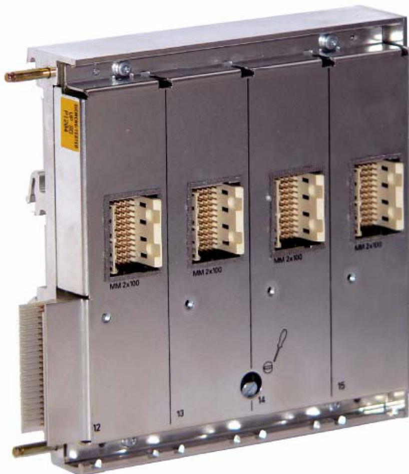
図 2-37 ポートに何も接続されていない状態のメディアモジュール用エクステンダ EM496-4（メディアモジュール端子台の保護キャップおよびカバーは未実装）
