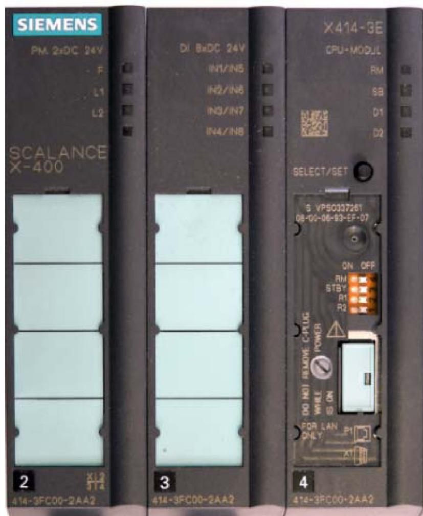
図 5-2 SCALANCE X414-3E の電源モジュール、デジタル入力モジュール、およびユーザ設定スイッチを備えた CPU モジュール
