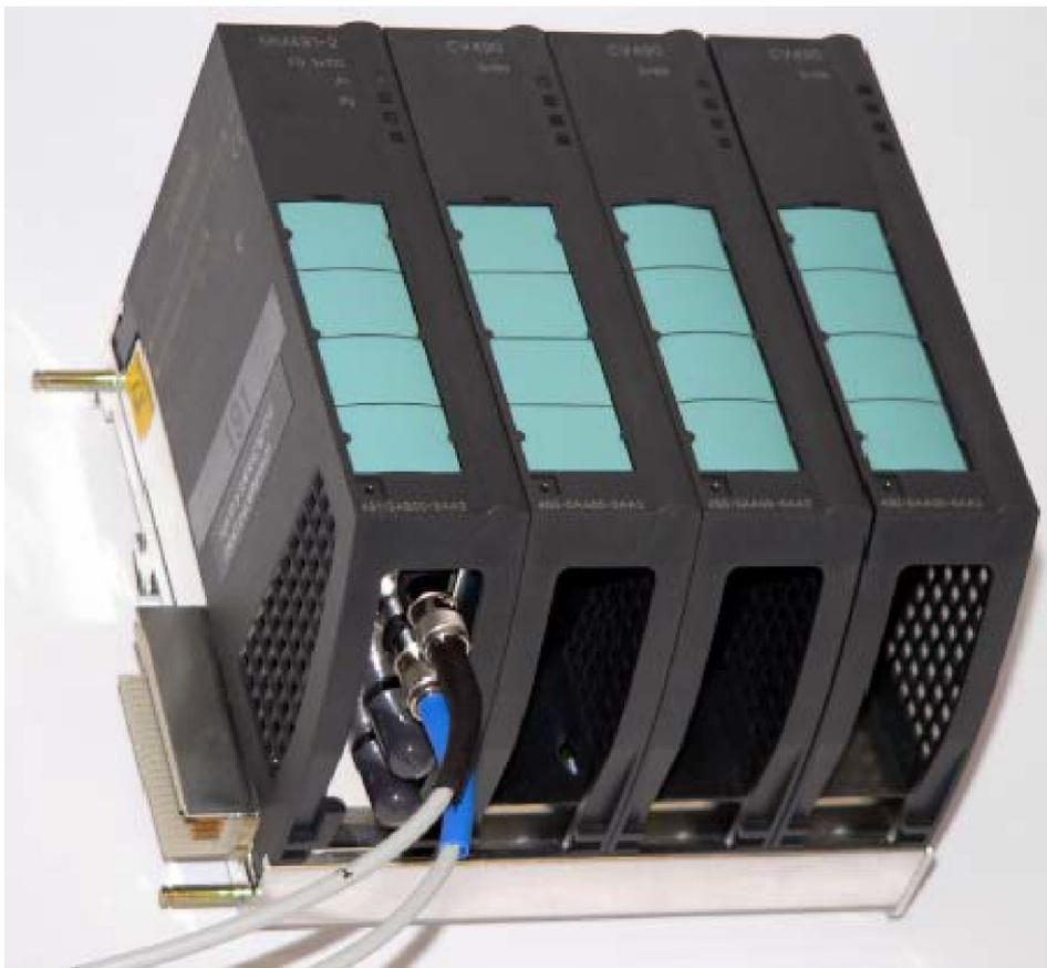
図 2-38 メディアモジュール用エクステンダ EM496-4 (メディアモジュール MM491-2 およびカバーを取り付けた状態)
