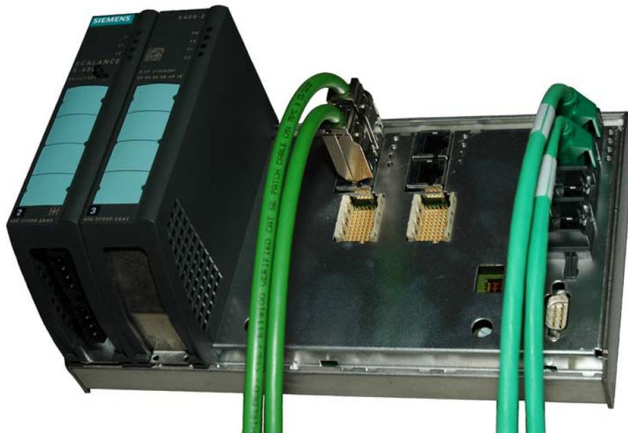
図 2-23 ギガビットの光ケーブルとファストイーサネットのツイストペアを接続した基本装置
