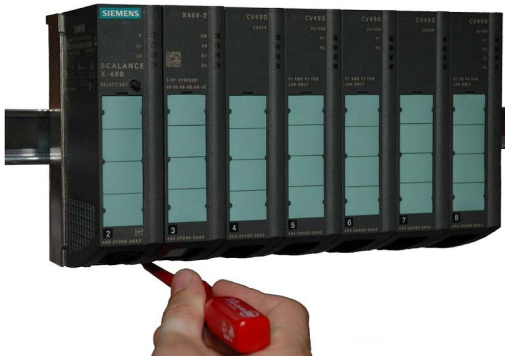
図 3-4 35mm DIN レールからの取り外し（SCALANCE X408-2 の場合）
