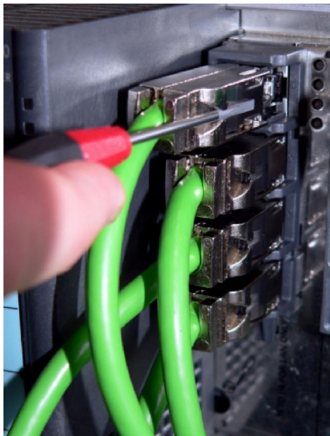
図 4-9 FC RJ-45 プラグのロック解除
