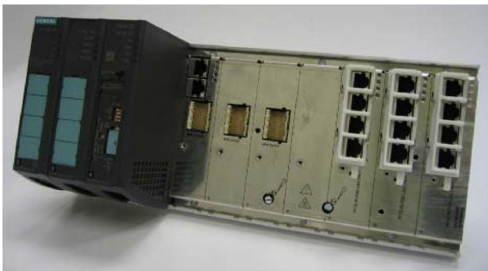
図 2-7 基本装置（メディアモジュール、保護キャップ、カバーは未実装）
