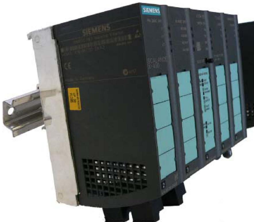
図 3-3 SCALANCE X414-3E の 35mm DIN レールへの取り付け
