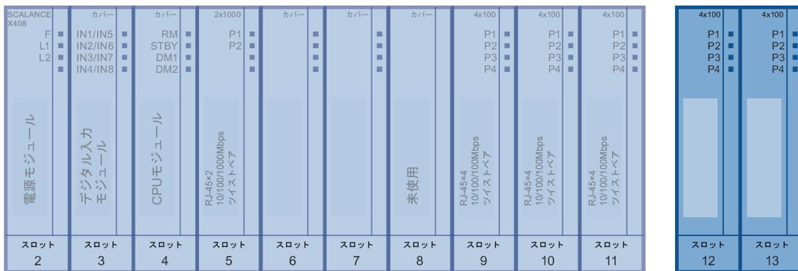
図 2-34 ツイストペア用エクステンダを実装した基本装置
