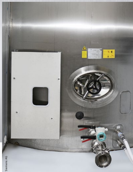
... sowie der Druckmessumformer Sitrans P D S III im Dauertest
