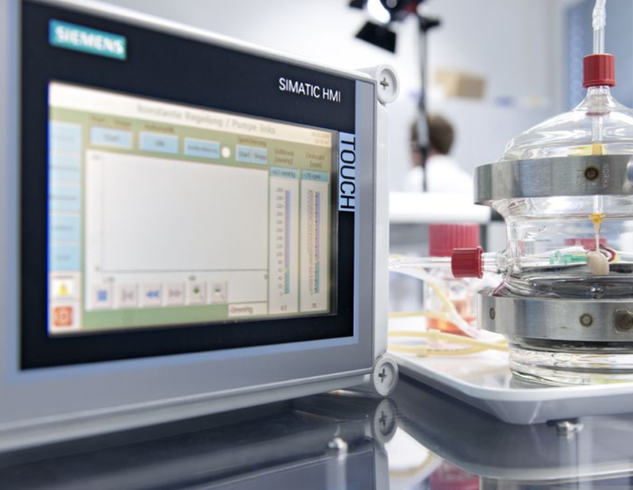
Simatic Comfort Panels sorgen dafür, dass die Forscher die Prozesse im Inkubator einfach steuern können
