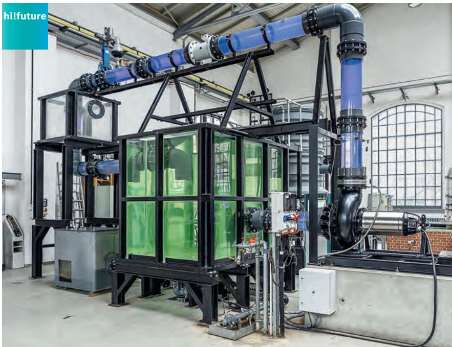
Ispitno postrojenje crpne stanice kojoj se postupno dodaje digitalni blizanac postrojenja.
