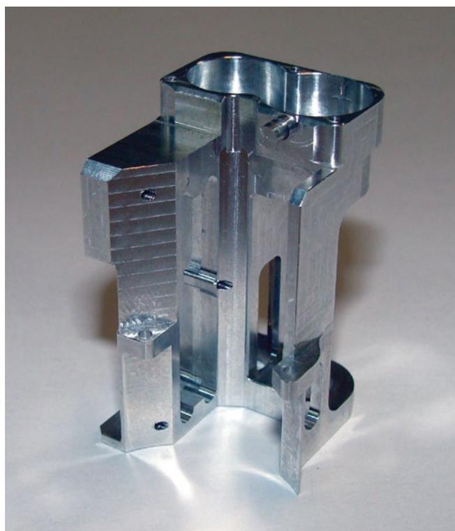
Mit der Software NX CAM und Fünffachs-CNC-Bearbeitungszentren fertigt C-Mill komplexe Präzisionsteile aus Hochleistungswerkstoffen für Anwendungen in Medizintechnik sowie Luft- und Raumfahrt.
