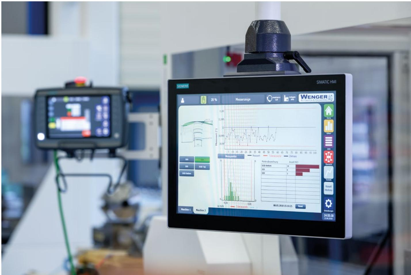
Das Herz der Portalanlage ist das Motion Control System Simotion von Siemens. Bedient wird die Anlage mit Simatic HMI Mobile Panels KTP900F (links), visualisiert werden die Prozess- Messdaten auf dem Simatic HMI TP1900 Comfort Panel Pro.
