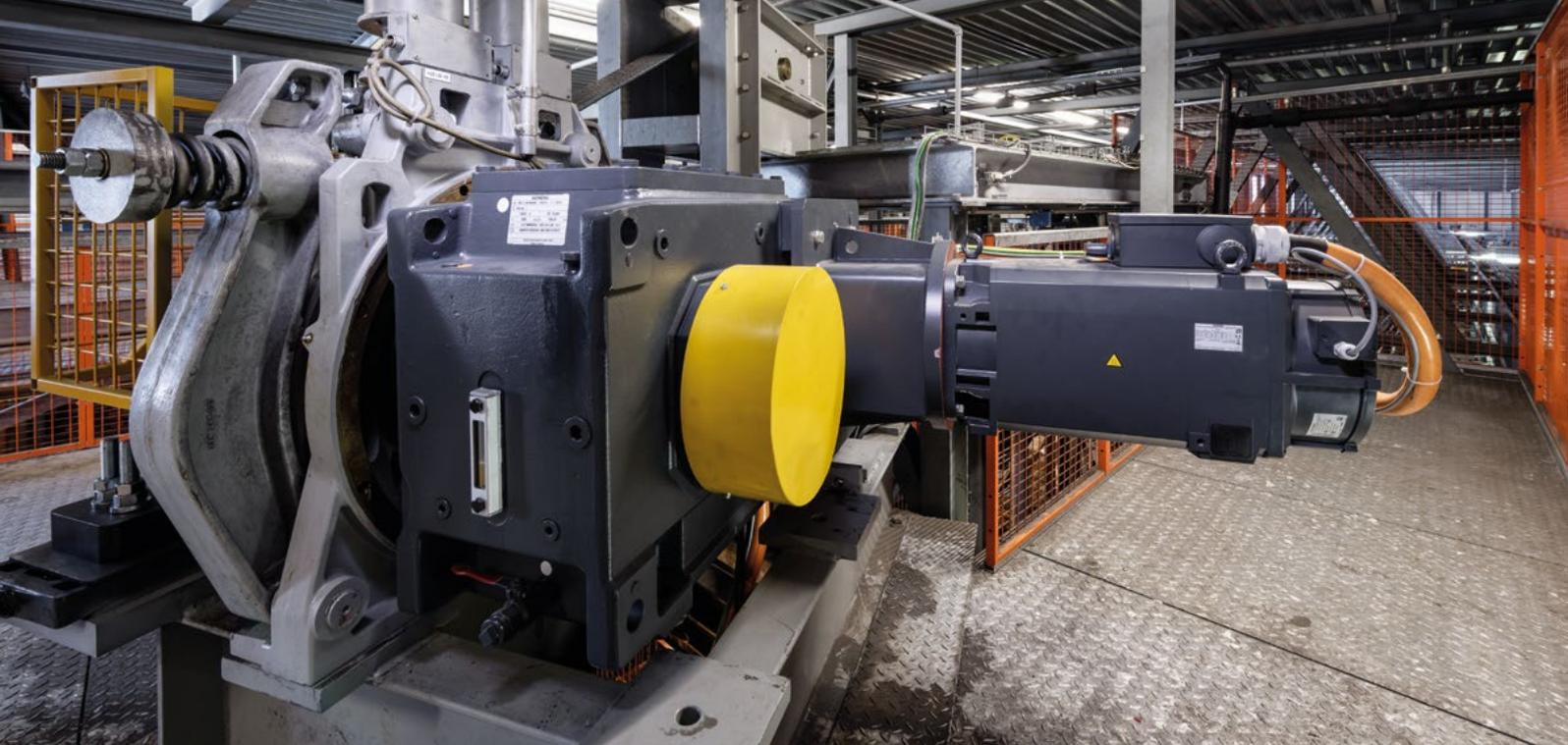
Eine kompakte Lösung: Die Lifte werden von einem Asynchronmotor Simotics 1PH8 in Kombination mit einem FZG Industriegetriebe H2DH09 der Siemens-Tochter Flender bewegt.
