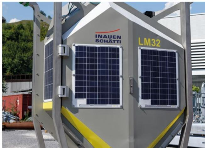
Der Magazinkasten ist autark: Rundum sind Solarzellen montiert, die genügend Strom für den Betrieb produzieren, auch an schattigen Lagen.
