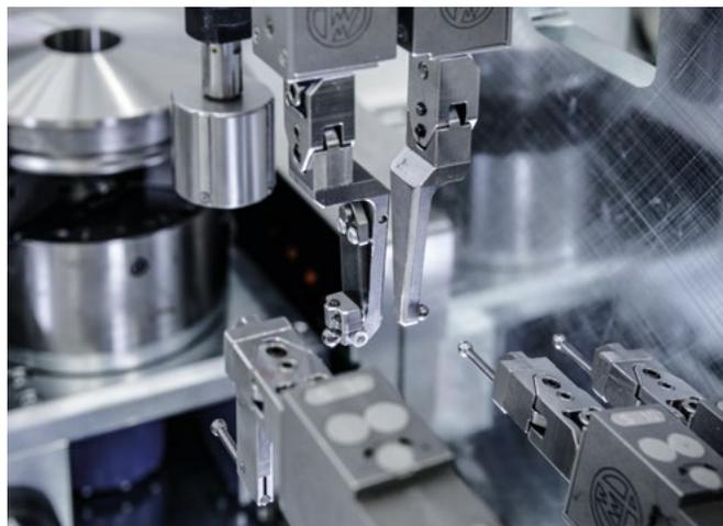
Das Innere der Messstation: Neben den taktilen Messarmen ist auch ein pneumatischer Messdorn (oben) eingebaut. Die Messsysteme erfassen fünf Parameter der geschliffenen Teile.
