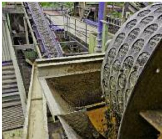
Eine der Siebtrommeln im Betrieb: hier wird der Sand vom Kies durch Auswaschen abgetrennt.
