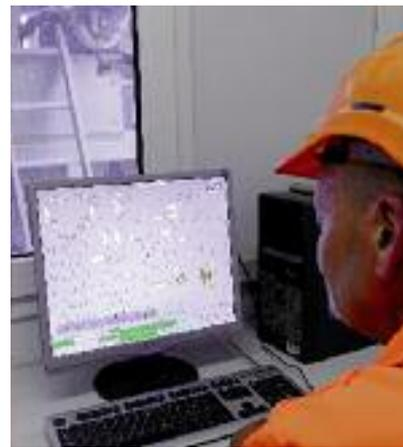
René Häberli, Werkmeister der Kibag Kies AG in Schafisheim, hat gleich einen zweifachen Blick auf seine Anlage: einmal durch das Fenster und ein zweites Mal über die Visualisierung auf dem Bildschirm dank der Siemens-Software WinCC flexible. Hier werden auch alle Störungen und deren genauer Ort dargestellt.
