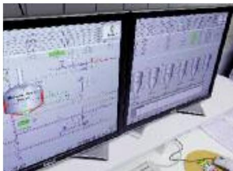
Die Bedienoberfläche von Braumat Compact für die Prozesssteuerung und -überwachung.
