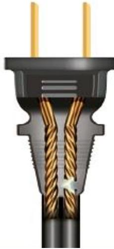
Rotura de un conductor.
