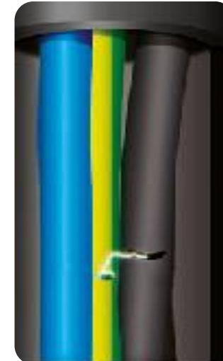
Contacto entre una fase y la protección en el conductor.
