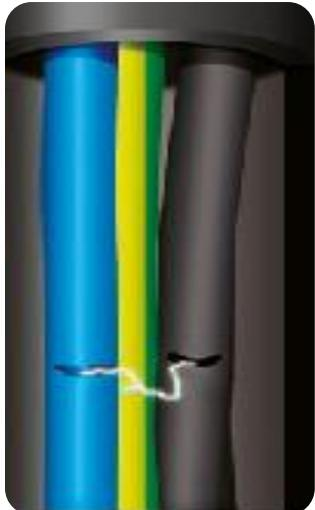
Contacto entre fase y neutro en un conductor.
