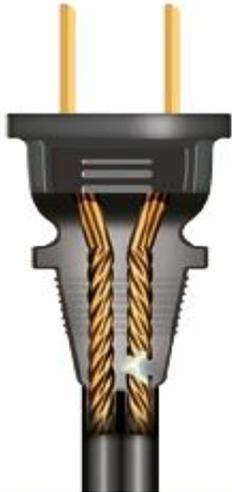
Rotura de un conductor.
