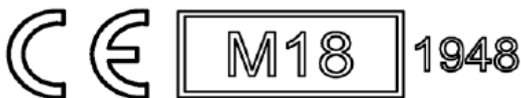
Abbildung: Kennzeichnung PAC2200CLP für EU-Elektrizitätszähler nach § 14 Abs. 1 MessEV
