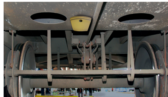
Controlguide CTsensor unter einem Güterwagen
