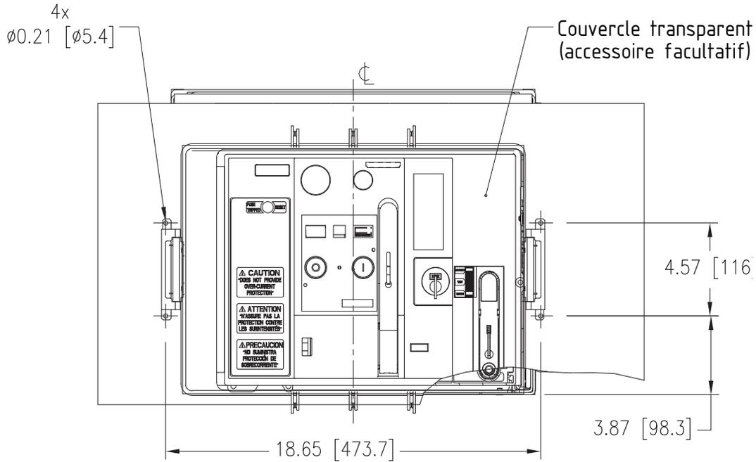
4 trous de chaque côté, en tant que points de montage arrière de recharge, peuvent être utilisés pour fixer la base au tableau de distribution  $\varnothing 0,22$  [5,5] pour vis autotaraudeuses M6
