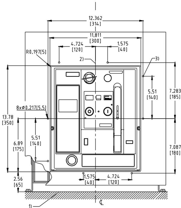
Découpe de porte et trous de montage pour châssis de guidage de porte
