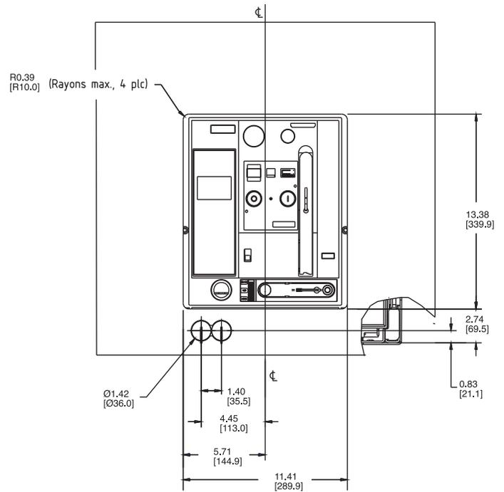
Découpe de porte et trous de montage pour châssis de guidage de porte
