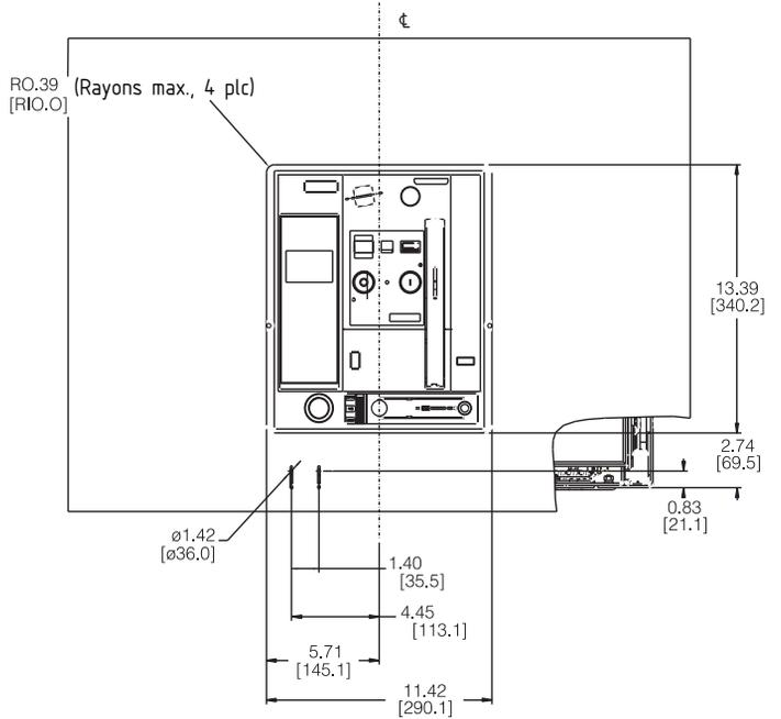
**Découpe de porte et trous de montage pour châssis de guidage de porte**
