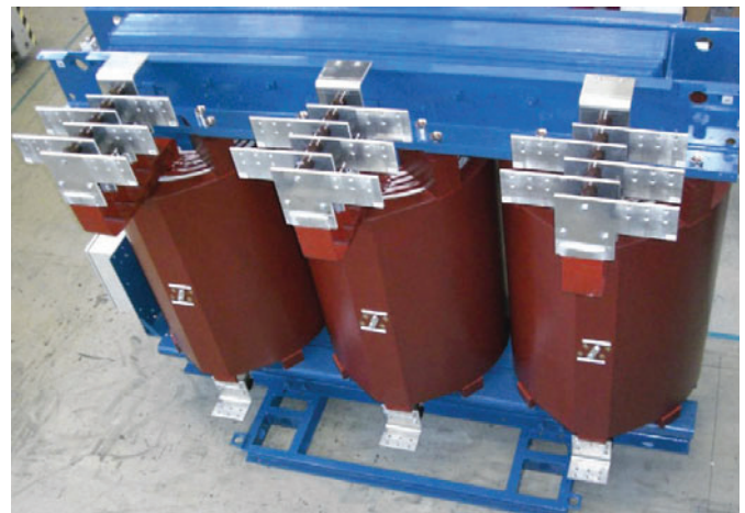
Рис. 5.9-12: 4771 кВА преобразовательный трансформатор GEAFOI с 5 вторичными обмотками со ступенями регулирования 10/0.33-2.4кВ
