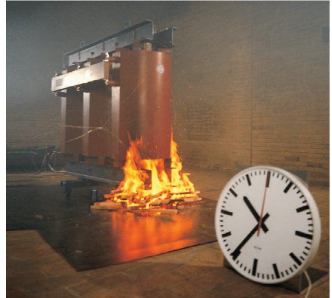
Рис. 5.9-6: Испытания воспламеняемости трансформатора из литевой смолы
