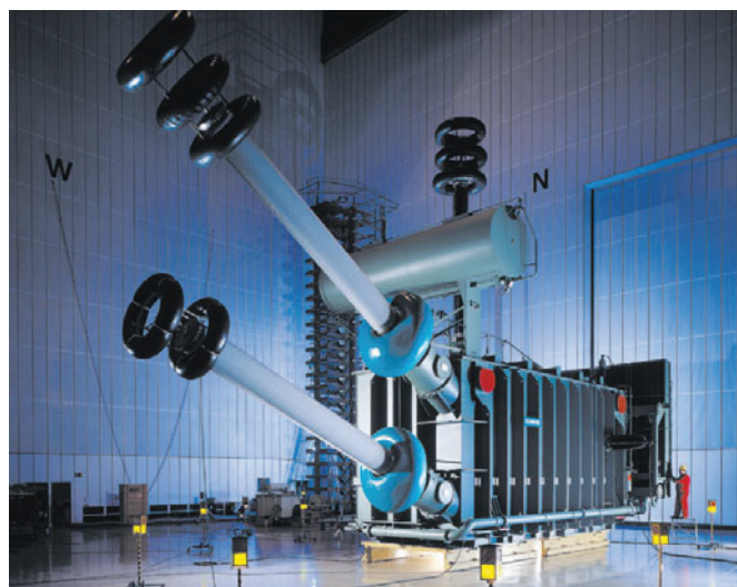
Рис. 5.8-2: Преобразовательный трансформатор для линий постоянного тока для двухполюсной системы передачи \pm 500 кВ постоянного тока 2500 МВт: однофазный; 420 кВ переменного тока; 515 кВ постоянного тока; 397 МВА; схема соединения «звезда» (слева на рисунке) и «треугольник» (справа на рисунке)
