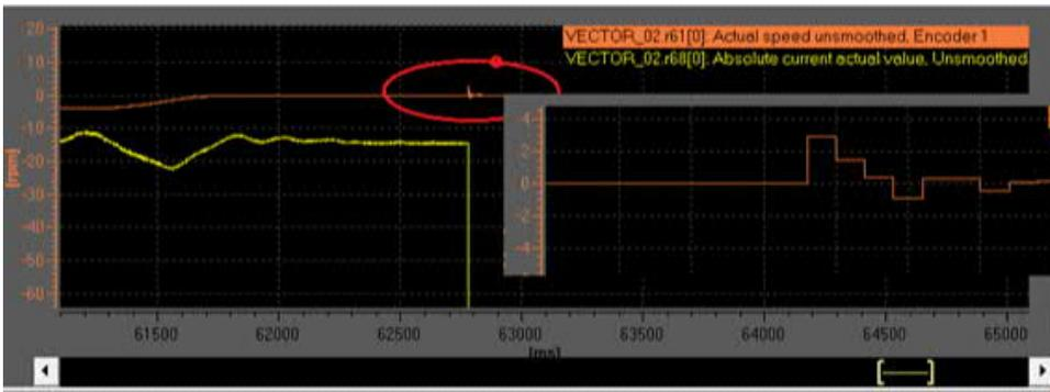
电机零速停车速度曲线
