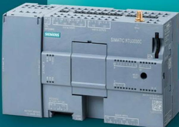
**SIMATIC 3010C/RTU3030C** – компактные удаленные терминалы данных контролируют удаленные точки измерения даже в тех местах, где нет источника питания
