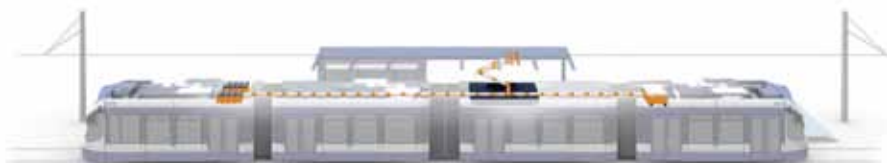
Aufladen der Energiespeicher auf Oberleitungsstrecken sowie durch Ladestationen an Haltestellen innerhalb weniger Sekunden
