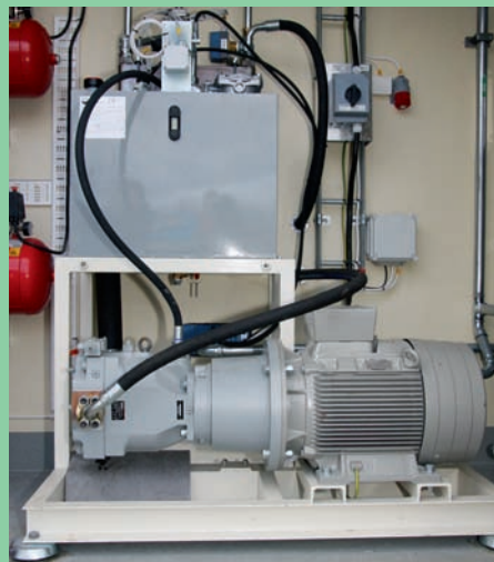
Stora kompressorer från Dresser Wayne drivs av Siemens lågspänningsmotorer 1LG4 och arbetar långsamt upp ett högt tryck för energieffektiv gastankning under natten.
