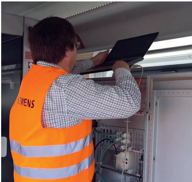
Bild 4: Der Laptop mit der RBC-Simulation wird an die OBU angeschlossen.
