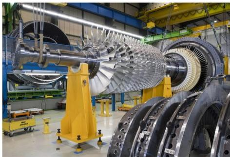
Abbildung 1: Gasturbine, kontinuierliche Verdichtung, Verbrennung und Expansion
