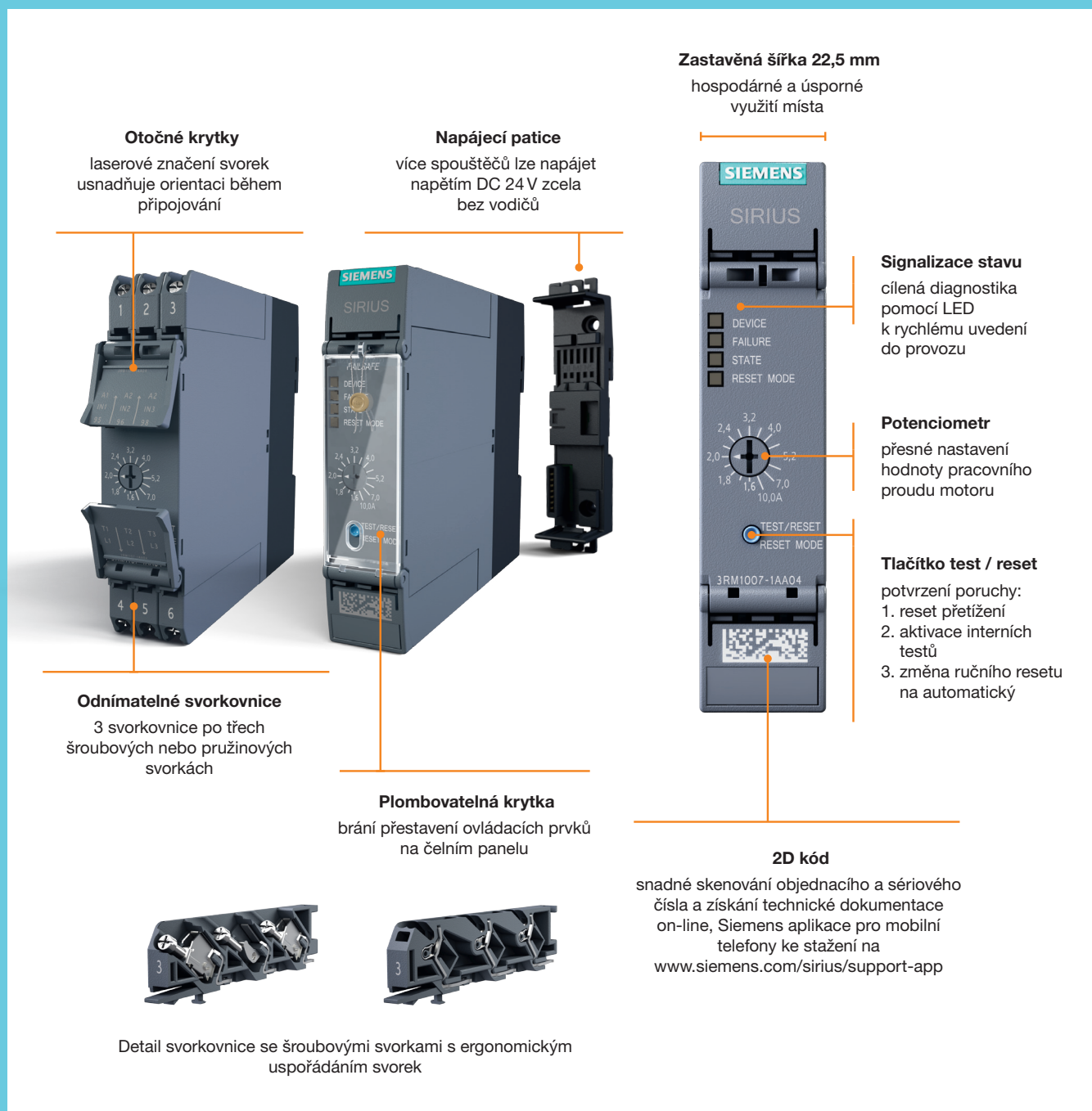
▲ Obr. 4: Koncept a vlastnosti zapouzdření spouštěčů 3RM1.
