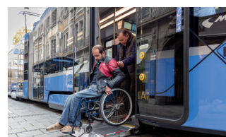
Ein Rollstuhllift ermöglicht mobilitätseingeschränkten Fahrgästen einen barrierefreien Einstieg auch vom Straßenniveau.
