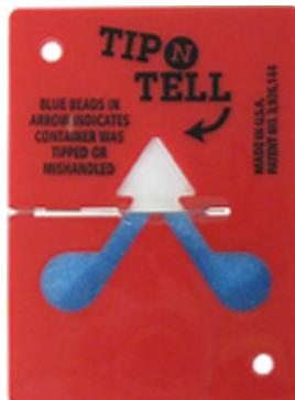
Esquema 3-2 Indicador de basculamento
