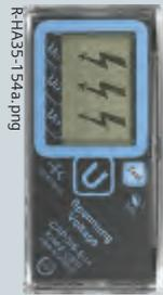
Встроенная система обнаружения напряжения CAPDIS-S1+, -S2+
