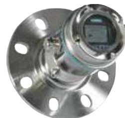
SITRANS LR560 2 线制、78 GHz FMCW 雷达料位变送器，用于连续监测料仓中的固体料位，高达 100 m
