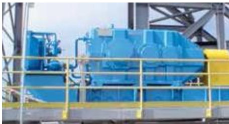
配备齿轮箱 B3SH26 和外置油冷却器 OLGE 09/V2 的带式输送机驱动系统，工作转矩 439,220 Nm，额定功率 2052 kW，输入转速 980 转/分，传动比 22.4。
