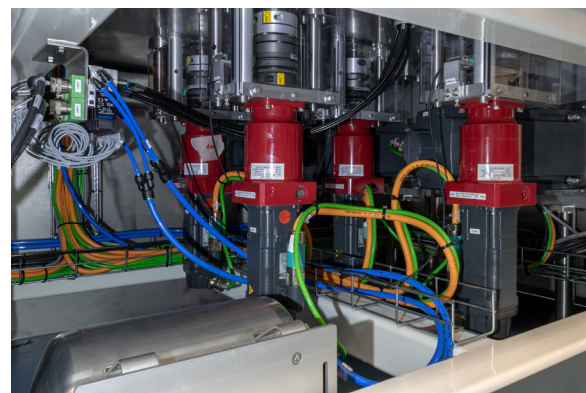
Vue de dessous : apparaissent les servomoteurs qui entraînent, via les réducteurs, les roues et les vis sans fin.
