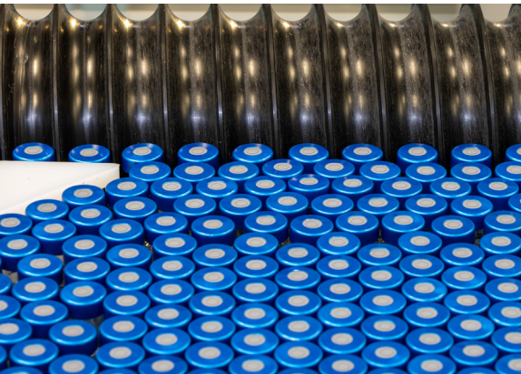
En entrée, une vis sans fin entraîne les flacons...
