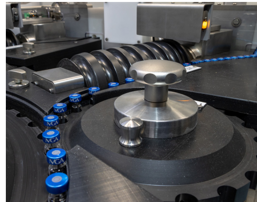
Après marquage, les flacons sont orientés au flacon près vers une des trois voies de sortie.
