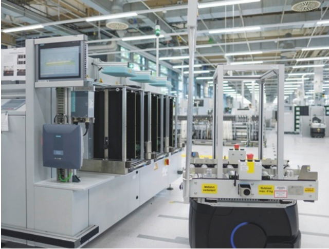
Ein Kernkonzept in der Karlsruher Fertigungsstrategie ist der Einsatz von autonomen Transportfahrzeugen für den Materialfluss im Werk.
