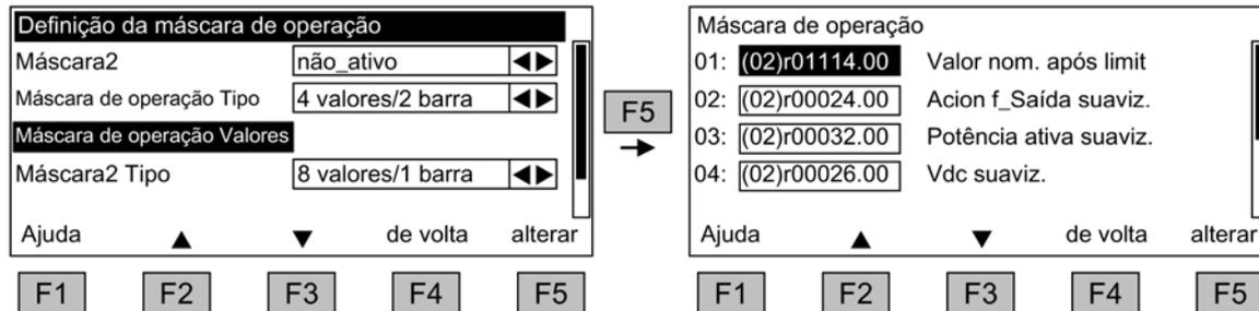
Esquema 5-6 Definição da máscara de operação
