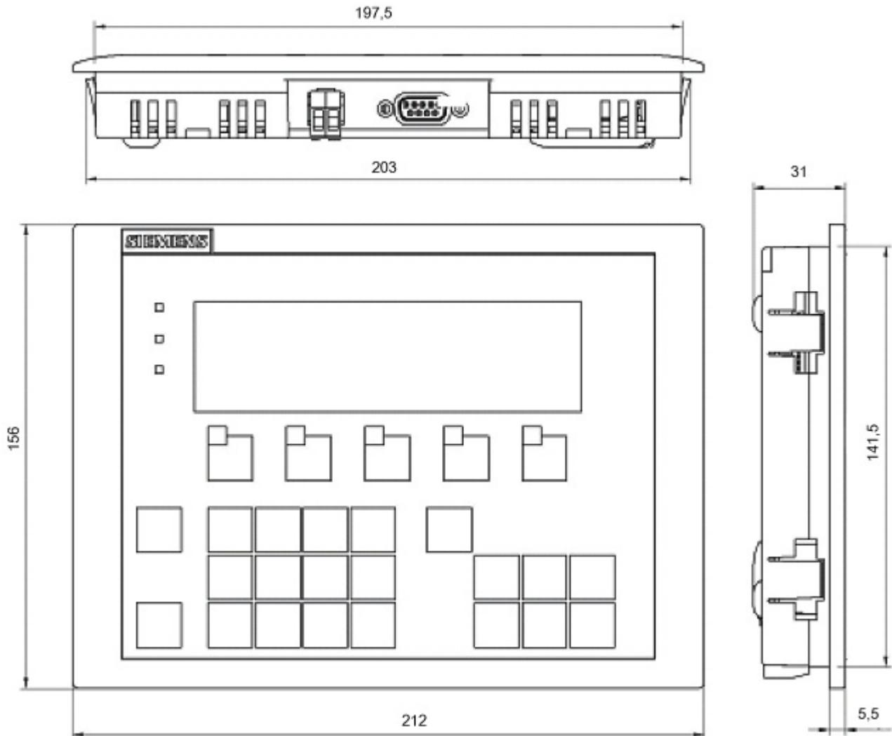
Esquema 3-1 Desenho de dimensões do painel de controle AOP30
