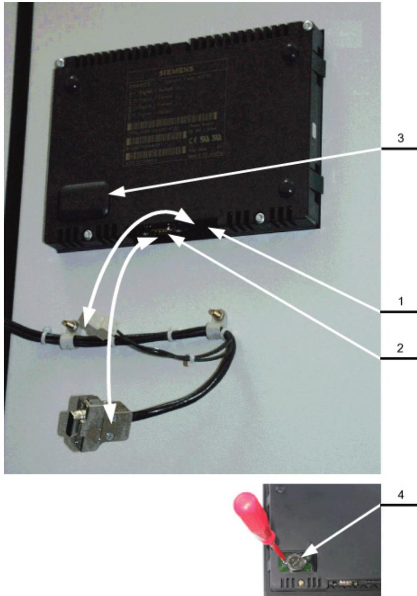
Esquema 6-1 Substituição da bateria de backup
