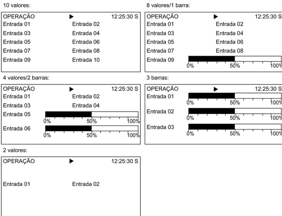
Esquema 5-7 Posições das entradas na máscara de operação
