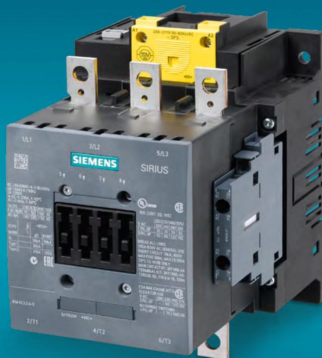
Disponibles en tailles S6 à S12 et offrant de 55 à 250 kW (3 ph., 400 V), les contacteurs éprouvés comprennent maintenant des versions adaptées à la commande directe de contrôleurs de sécurité, rendant le niveau de couplage superflu. Les nouveaux contacteurs sont également disponibles avec des contacts auxiliaires latéraux non amovibles, ce qui permet de répondre aux exigences de la SUVA (Caisse nationale suisse d'assurance en cas d'accidents).
