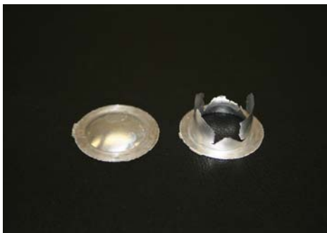
Abbildung 2: Berstscheiben nach der Druck-Zeit-Prüfung (exemplarisch)
