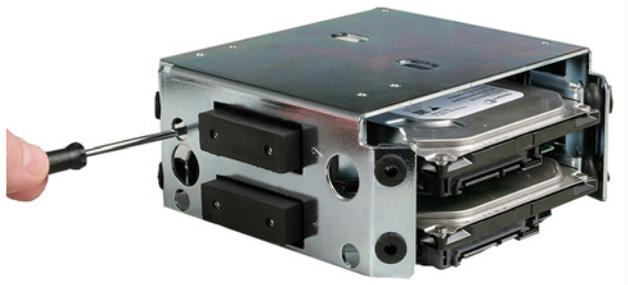
10.4.4 固定ハードディスクラックへのハードディスクドライブの取り付けと取り外し
