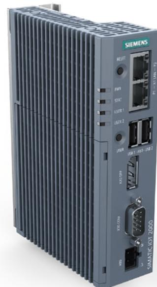
Mit IoT-Gateways lassen sich zukunftsgerichtete Fertigungskonzepte in einer bestehenden Anlage realisieren. Die neue Generation verfügt über eine deutlich verbesserte Performance: Simatic IOT2000 vereint die neueste Prozessorgeneration mit 2 GB DDR4 RAM mit integriertem eMMC-Speicher und vorinstalliertem Simatic Industrial OS.
