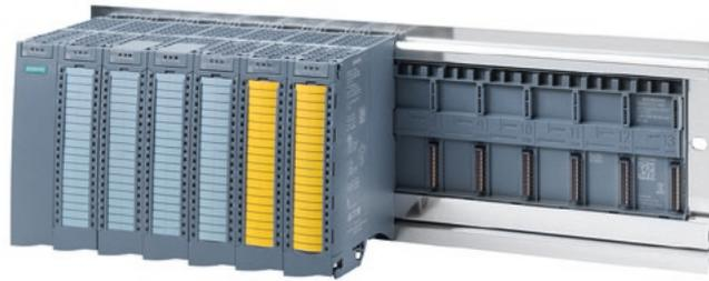
Die neuen hochkanaligen Module für Simatic ET 200MP/S7-1500 minimieren den Footprint von dezentralen und zentralen Stationen. Insgesamt vier neue Digitalmodule mit je 64 Kanälen und zwei Analogmodule mit je 16 Kanälen ermöglichen eine platzsparende und kosteneffiziente Montage von hohen Kanalzahlen im Schaltschrank. Mit dem neuen aktiven Rückwandbus für dezentrale Simatic ET 200MP-Stationen ist ein Hot Swapping von Modulen möglich: Falls Module ausfallen, können diese bei
