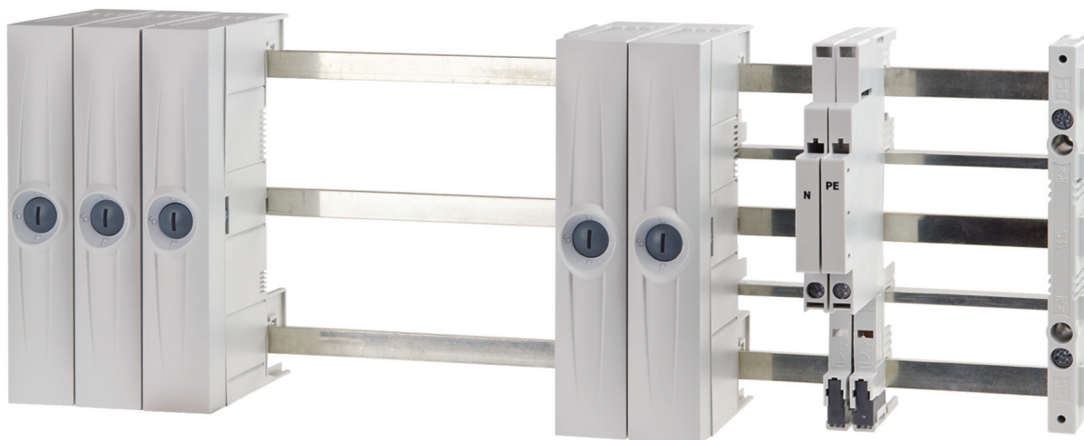
Figura 3.2 - O sistema de barramento compacto de 3/5 pólos 60 mm para a faixa de desempenho inferior até 360A; os elementos de 5 polos são projetados apenas para até 200A
