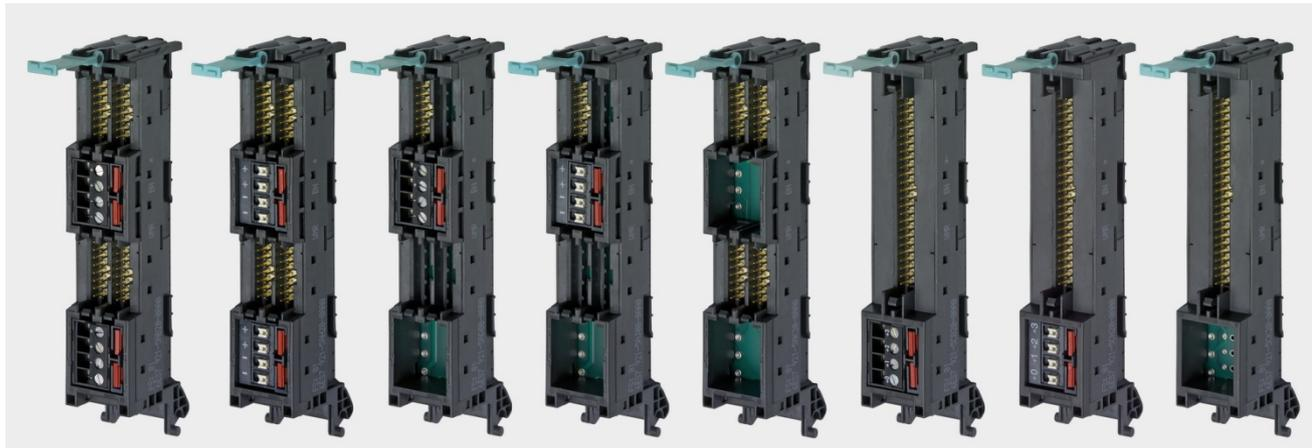
Фронтальный соединительный модуль SIMATIC TOP Connect устанавливается на дискретный или аналоговый модуль контроллера S7-1500/ станции ET 200MP вместо стандартного фронтального соединителя. Каждый фронтальный соеди-
