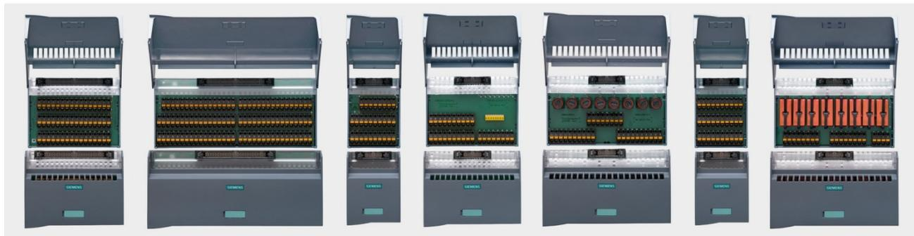
Терминальные модули SIMATIC TOP Connect формируют интерфейс между внутренними и внешними цепями шкафов управления. Они монтируются на стандартную 35 мм профильную шину DIN и оснащены разъемом для подключения соединительного кабеля SIMATIC TOP Connect, а также набором контактов под винт или отжимных контактов для подключения внешних цепей (цепей датчиков и исполнительных устройств).
