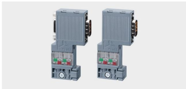
Для подключения электрических кабелей к встроенным интерфейсам PROFIBUS центральных процессоров и коммуникационных модулей S7-1500 находят применение 9-полюсные штекеры RS 485. Соединители имеют модификации с встроенным или без встроенного гнезда для подключения программатора. Соединители с встроенным гнездом для подключения программатора позволяют подключать программатор без разрыва коммуникационных соединений через PROFIBUS.
