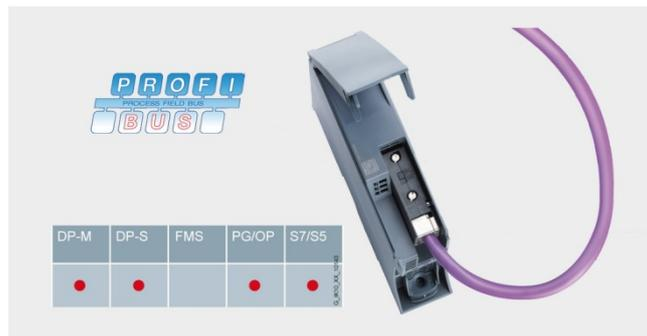
Коммуникационный модуль CM 1542-5 предназначен для подключения программируемого контроллера S7-1500 к сети PROFIBUS. Он способен выполнять функции ведущего или ведомого DP устройства и поддерживать обмен данными со скоростью от 9.6 Кбит/с до 12 Мбит/с. Все коммуникационные задачи модуль обрабатывает самостоятельно с минимальной нагрузкой для центрального процессора.
