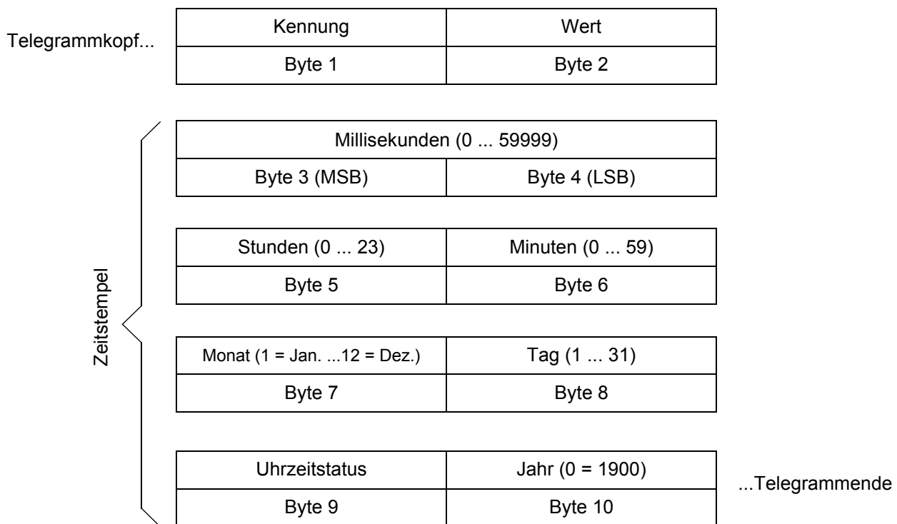
Bild 3-9 Datentyp Meldeblock für Meldeliste über PROFIBUS-DP
