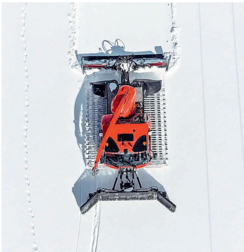
Echipamentele pentru amenajarea pistelor pot măsura în timp real stratul de zăpadă de pe pârtii.
