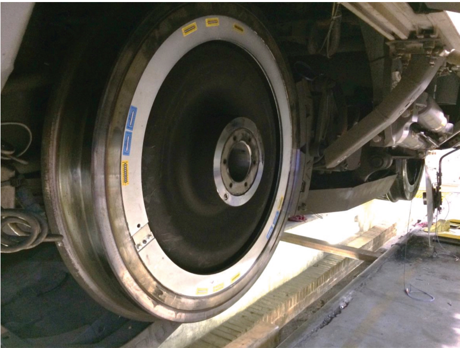
Bild 9: Schallabsorber-Erprobung im Hochgeschwindigkeits-Einsatz (Velaro Novo) zur Reduktion des Rollgeräuschs
