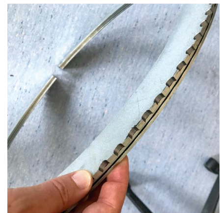
Bild 8: Schallabsorbervariante für den Metro-Einsatz (Klotzbremse)
