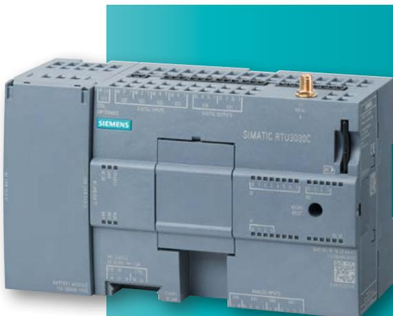
**SIMATIC 3010C/ RTU3030C** — компактные дистанционные терминалы для контроля удаленных точек измерения, даже в местах с полным отсутствием электропитания.
