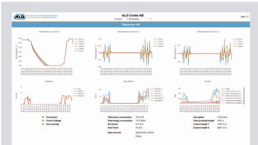
Översikt med hastigheter, gasflöden, effekter, temperaturer, energiförbrukning och drifttid för hela hårdlinjen.
