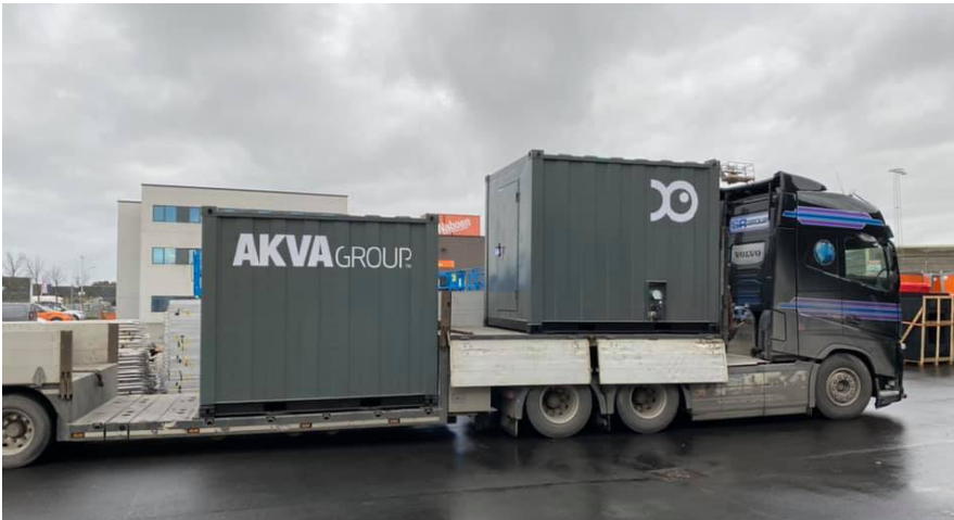
Batterikontainere fraktes til anleggsområder uten nett for lading av elektriske anleggsmaskiner.
