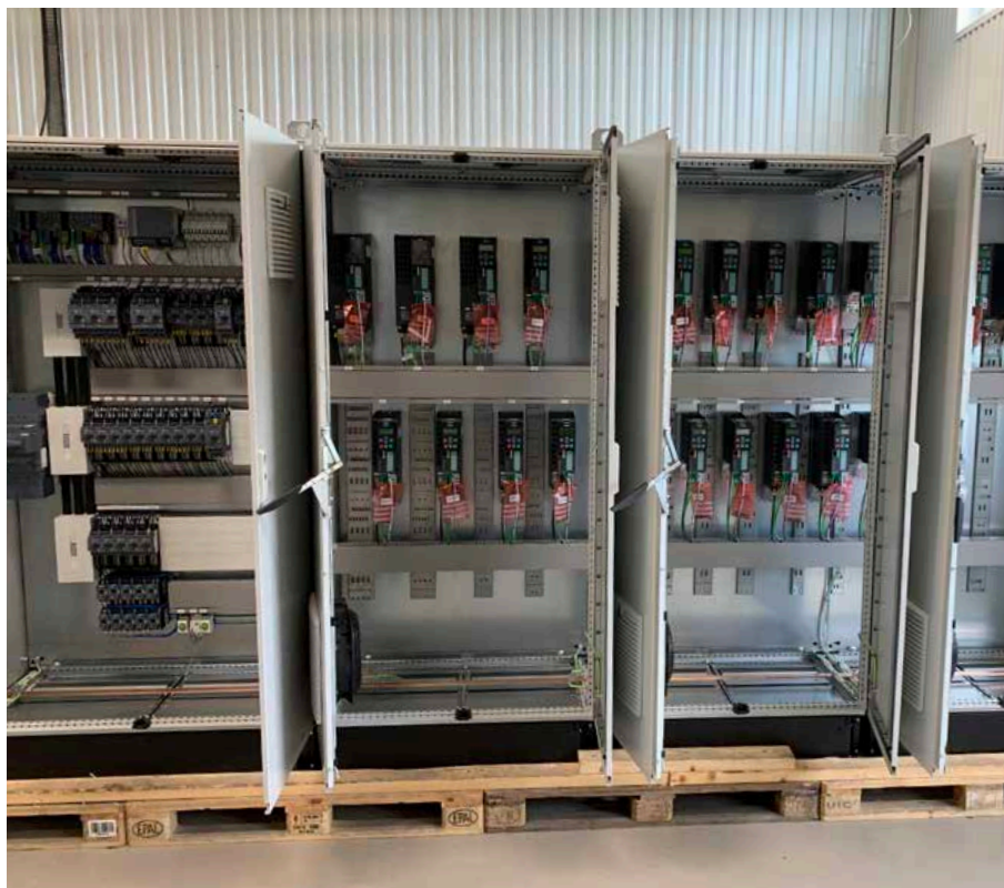
Snyggt montage med skenor för motorkablar som ger en effektiv installation och EMC-kompatibilitet. Alla frekvensomriktare kommer med inbyggd 2-portarsswitch för Profinet, vilket innebär att man kan hålla nere kabeldragningen.
