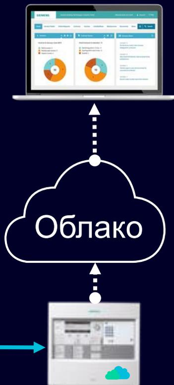
Пожарная контрольная панель со встроенным шлюзом X200
