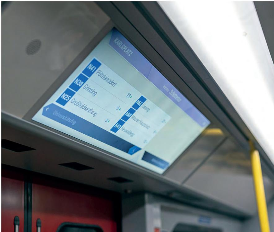
**Bild 7:** Monitor zur Anzeige der Inhalte der PI+ über jeder Fahrgasttür
