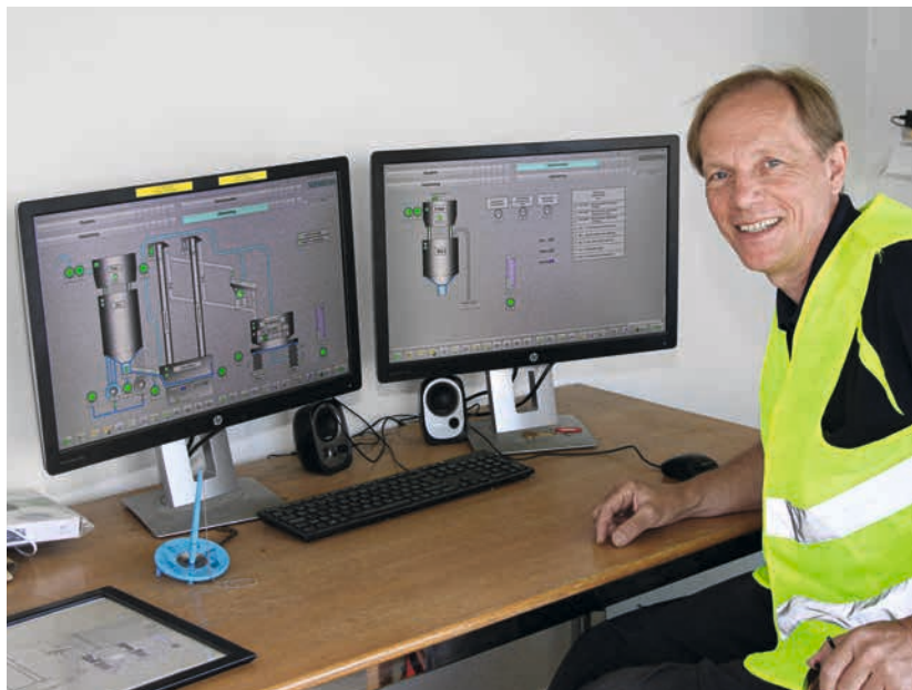
Simatic PCS 7, som normalt används i kontrollrum, används här på obemannade depåstationer. Vid problem skickas sms-larm och operatörerna kan se och felsöka felen på skärmarna.
