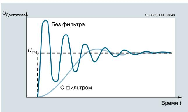
Типичная последовательность напряжения преобразователя  $U_{\text{ПЧ}}$  и напряжения электродвигателя  $U_{\text{Двигателя}}$  на ШИМ-преобразователе (преобразователь с выходным фильтром и без него)
